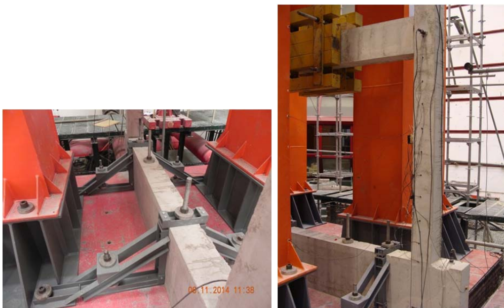
Figura 5 – Ligação da viga de fundação à plataforma sísmica
