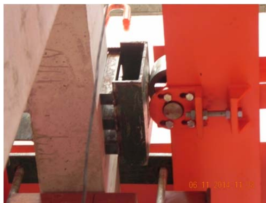
Figura 2 – Estrutura auxiliar de guiamento: vista geral (esq.) e pormenor dos roletes de guiamento (dir.)
